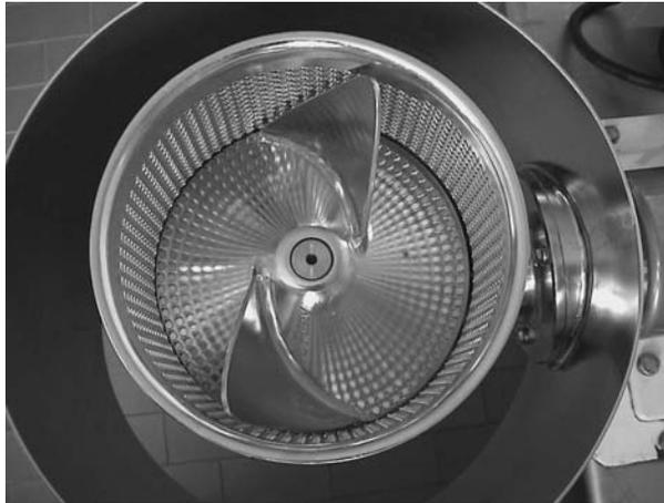
**Abb. 4-3:** Aufsicht auf ein Raspelsieb (Reibschneider) zur Feuchtsiebung von Mischergranulaten im Labormaßstab.
